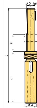
**Inserto porta pinze per utensili a gambo cilindrico (DIN 6327)**
