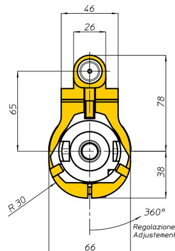
Teste ad angolo TA13.CP, TA16.CP con interasse H=65
