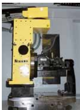
CNC401T instalado sobre pallet de un centro horizontal
