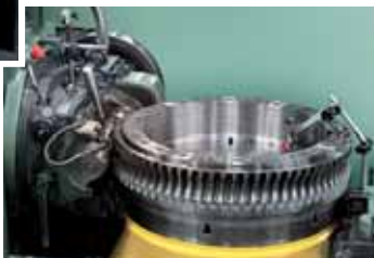
Tallado de los engranajes con modulo grande.
